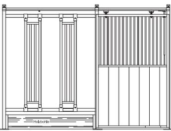
Vorderfront mit Sicherheits-Durchfressgitter & Schiebetür Holz/Gitter
